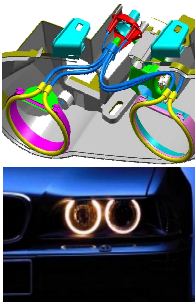
Abb.4: Lichtleitringe als Positionslicht, versorgt mittels flexibler Lichtleiterbündel
