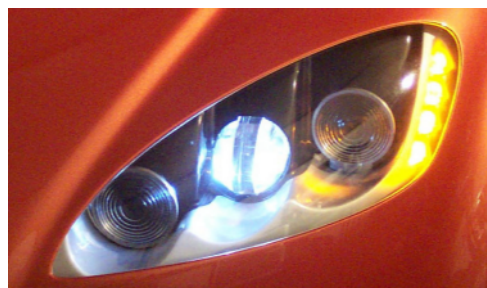
Abb.6: Multifunktionaler Lichtleiterscheinwerfer im Volvo Konzept Auto SCC2 [3]
