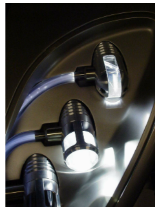
Abb.5: Bi-funktionaler Lichtleiterscheinwerfer im DC Forschungsfahrzeug F400 Carving [2]
