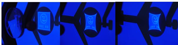
Abb. 1 Beleuchtungsverteilung mit einer Freiform-Linse. Effekt globaler Justierung. Links: korrekte Lage. Mitte: defokussiert in Richtung Zielfläche. Rechts: verkippt.
