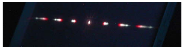
Abb. 2 Beugungsbild eines ultrakurzen Pulses hinter einem Phasengitter
