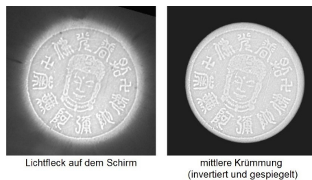
Abb. 4 Intensitätsbild des durch den Spiegel erzeugten Lichtflecks und PMD-Messergebnis.
