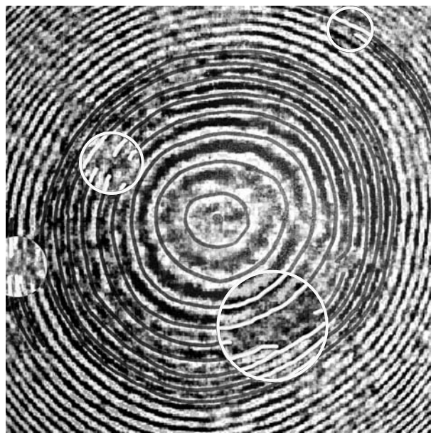
Abb. 5 Rauschen und Speckle in Kamera-Signal, problematische Zonen sind markiert
