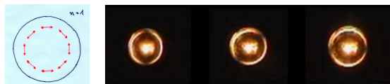
Abb.3 Azimutalpolarisator nach Abb.2 im linearpolarisierten Licht verschiedener Orientierungen aber ohne Blende B
