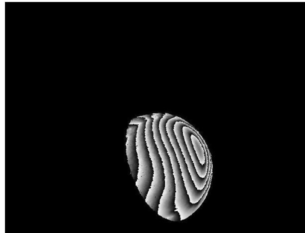
Abbildung 3 3D-Punktwolke eines tt-Balles, welche mit Phasenwerten gemappt wurde, einschließlich der durch die Deformation erzeugten Interferenzstreifen
