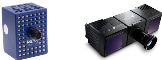
Abb. 1 Bisher erfolgt die Objektbeleuchtung meist mit IR-LEDs geringer Lichtleistung ohne weitere Kollimationsoptik; z. B.: Mesa Swissranger SR 3000 (links) und PMD Technologies CamCube 2.0 (rechts).
