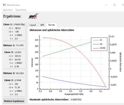
Abb. 1 Screenshot des Programms für das automatisierte Optikdesign
