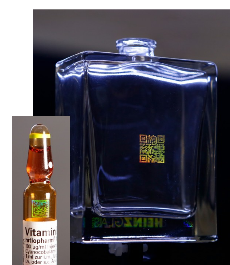
Diffraktive Markierung kommerzieller Glasgebilde mit DMC- (links) bzw. QR-Code (rechts)
