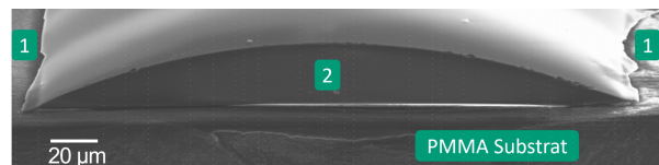
Abb. 2 SEM-Aufnahme eines gedruckten Polymer-Optischen Wellenleiters auf einem PMMA Substrat. (1) Flexographisch gedruckte Konditionierungslinien. (2) Mittels Aerosol Jet gedruckter Kern der Wellenleiter
