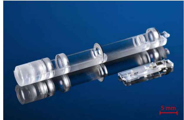
Abb. 4: Aufgebaute Optik (Hintergrund: Hinweg, Vordergrund: Rückweg) – © Fraunhofer ILT / Rainer Neumeyer
