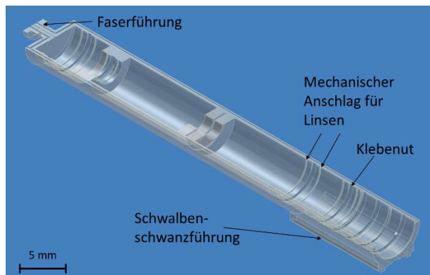
Abb. 3: CAD Modell obere Hälfte des Hinwegs
