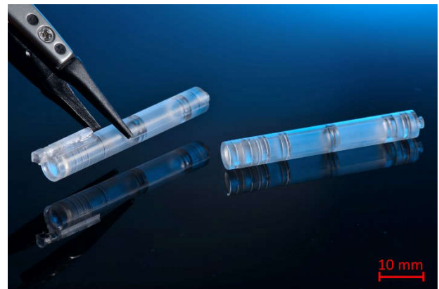
Abb. 5: Links: komplette Messsonde (Hin- und Rückweg) Rechts: Zusammengebauter Hinweg – © Fraunhofer ILT / Rainer Neumeyer
