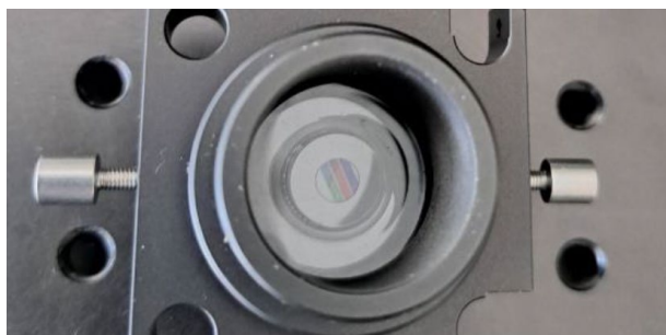
Abb. 2 Zu sehen sind drei in Silikon abgeformte optische Gitter, die alle in einem optischen Halter angebracht sind, um die Gitter im Strahlengang zu positionieren.
