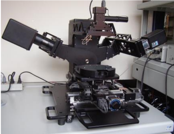
Abb. 5 Experimenteller Aufbau - Ellipsometer M-2000 DI von J.A.Woollam in PCrSA Konfiguration (Foto: BAM).
