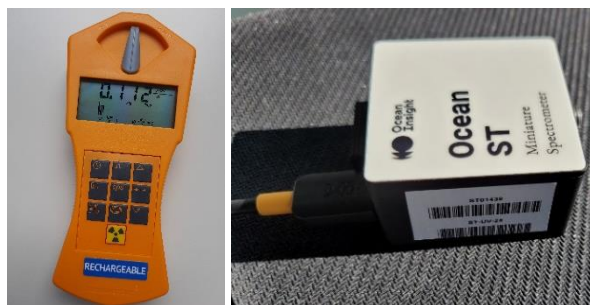
Abb. 2 Links: GAMMA-SCOUT Detektor ( \alpha -, \beta -, \gamma -Strahlung); rechts: Miniatur UV-VIS Spektrometer.
