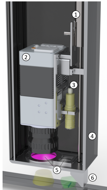
Fig. 2 Darstellung der Komponenten im Multisensorsystem: boroskopische Kamera (1), Thermografiekamera (2), Linienlaser (3) und Gehäuse (4) mit Schutzfenster (5) sowie optischem Filter (6).
