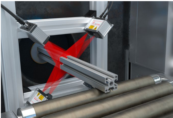
Abb. 1 Lichtschnittsystem als Beispielanwendung. [1]
