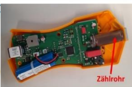
Abb. 8 Technische Parameter und Abbildung des Gamma Scout Dosimeters mit integriertem Geiger Müller Zähler.
